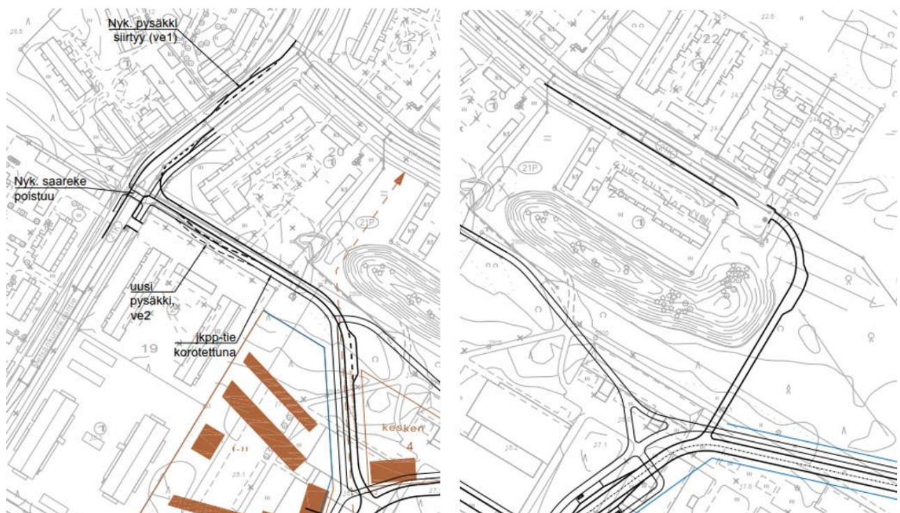
Kuva 30. Joukkoliikenteen ajoyhteyden vaihtoehtoisia linjauksia, vasemmalla Metsäkuninkaantielle suoraan ja oikealla Otsonkujan päähän. Kuva: Ramboll Finland Oy.
