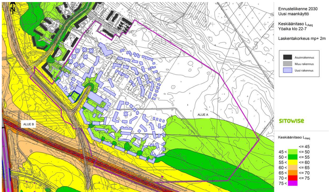
Kuva 16. Vuoden 2030 liikenne-ennuste, suunniteltu maankäyttö, yöaika. Kuva: Sitowise Oy.
